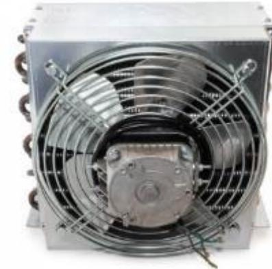
Der Verflüssiger ist ein **Wärmetauscher**, der **das vom Kompressor kommende Gas** auf die Verflüssigungstemperatur **abkühlt** und **wieder in den flüssigen Zustand bringt**.
