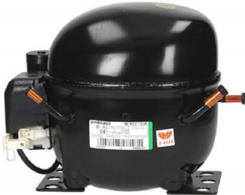
Der **hermetische Verdichter** umschließt in einem abgedichteten Gehäuse einen alternativen **Verdichter** und dessen **Elektromotor**. Diese sind durch eine Dauerschmierung unabhängig und durch einen Kältemittelkreislauf geschützt, der optimale Temperaturen für einen korrekten Betrieb gewährleistet.
